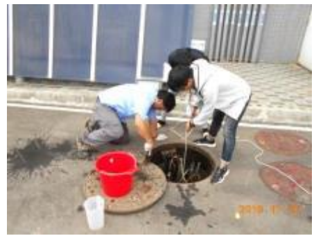
定期进行废水采样检测
